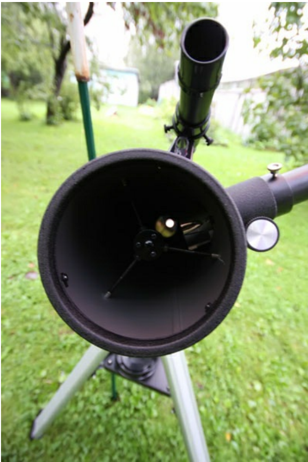
Оптический искатель с 6-кратным увеличением, расположенный достаточно высоко по отношению к трубе, снабжен крестом нитей, что позволяет быстро навести телескоп на нужный участок неба.
