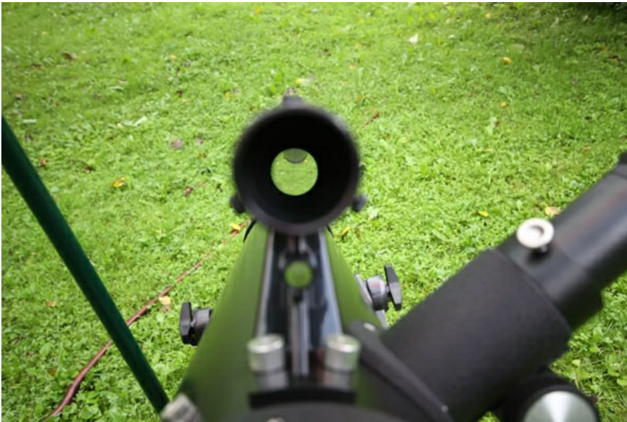
Оптический искатель с 6-кратным увеличением, расположенный достаточно высоко по отношению к трубе, снабжен крестом нитей, что позволяет быстро навести телескоп на нужный участок неба.
